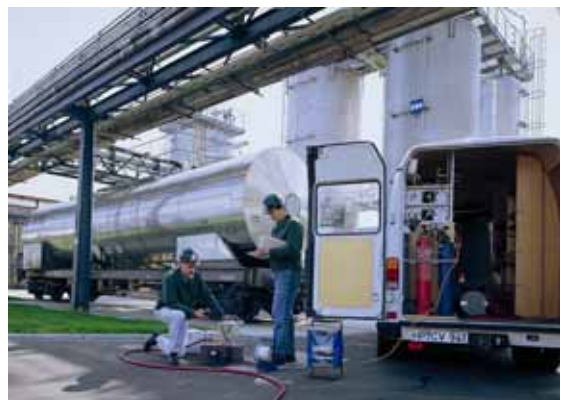
Mit dem Umweltmesswagen werden im Werksareal Proben für die Umweltanalytik gezogen.
